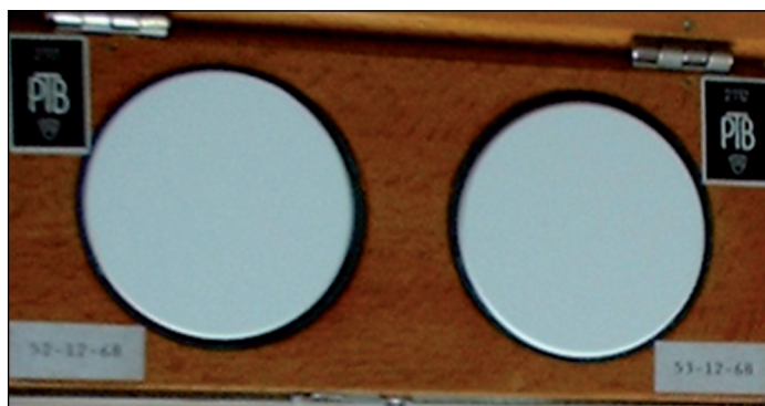
Еталонни бели сравнителни материали за спектрален коефициент на дифузно отражение във видимия обхват на спектъра
